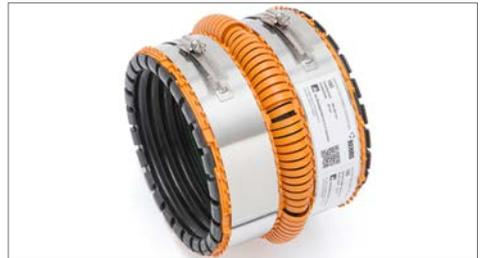
Die Norm DIN EN 476 „Allgemeine Anforderungen an Bauteile für Abwasserleitungen und -kanäle“ fordert: Rohrverbindungen dürfen bis DN/OD 315 oder DN/ID 300 einen Absatz von 6 mm (entspricht Innendurchmesserdifferenz 12 mm) nicht überschreiten.
